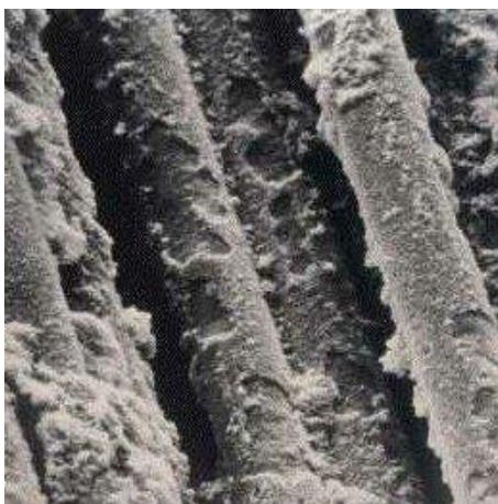
Bild 10: Auswirkung eines alkalischen Milieus auf Faser aus E-Glas (links) und AR-Glas (rechts) [Lit 70]
