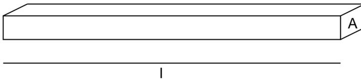
Beim Ziehen des Stabes mit einer Kraft  $F = 1000 \text{ kN}$  verlängert sich der Stab um  $0,012 \text{ m}$ , geht aber nach dem Nachlassen der Kraft wieder auf seine Ursprungslänge zurück. Seine Ursprungslänge  $l$  beträgt  $1 \text{ m}$  und seine Querschnittsfläche  $A$  beträgt  $4 \text{ cm}^2$ . Bestimmen Sie den E-Modul!
