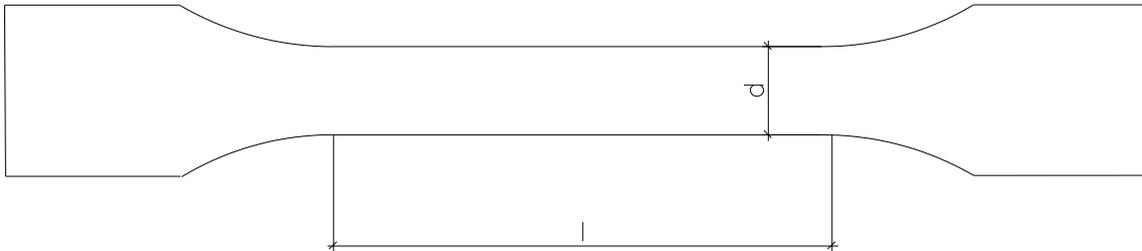
Abbildung 3.2: Zugprobengeometrie
