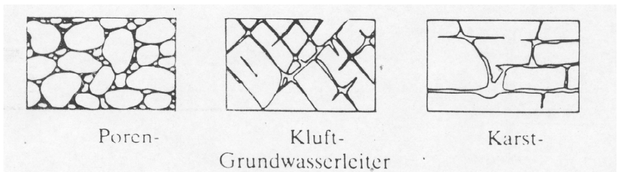
Abb. 3.3.5: Darstellung verschiedener Hohlräume im Untergrund. Poren finden sich vorwiegend in Lockergesteinen sowie (in Abhängigkeit von der Matrixausbildung) in klastischen Sedimentgesteinen. Klüfte können bei allen Festgesteinen auftreten. In magmatischen Gesteinen stellen sich die wichtigsten grundwasserleitenden Hohlräume dar. Karsthohlräume finden sich in Kalksteinen (auch Marmoren). Sie entstehen durch Lösung von \text{CaCO}_3 durch Kohlensäureverwitterung.
