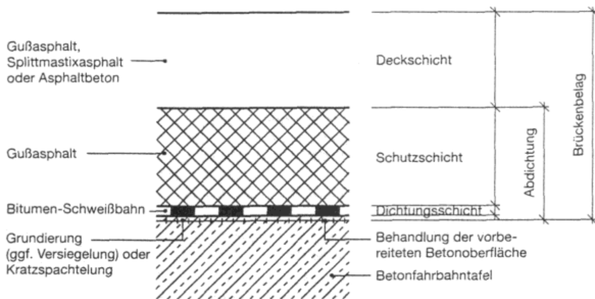
Bild 11: Prinzipskizze Brückenbelag mit Dichtungsschicht aus einer Bitumen-Schweißbahn
