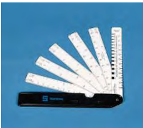
Bild 30: Messstreifenset für unterschiedliche Rissbreiten
