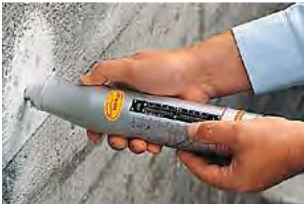
Bild 37: Rückprallhammer nach Schmidt [Lit 33]
