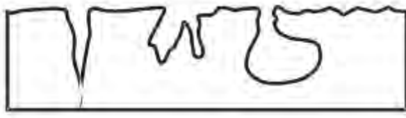
Bild 65: Formen der Lochkorrosion
