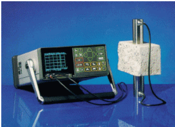
Bild 48: Ultraschallmessgerät mit Sender und Empfänger [Lit 89]
