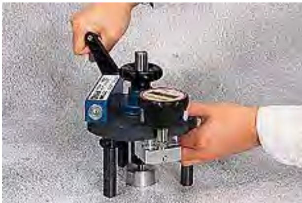
Bild 41: Haftprüfgerät mit Digitalmanometer [Lit 77]
