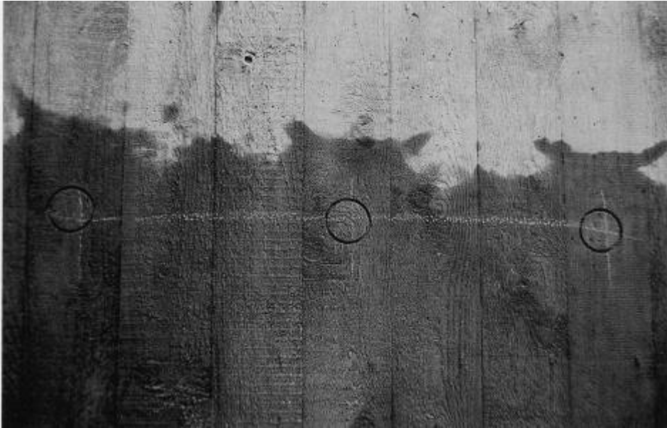
Bild 39: Vorbereitende Ringnutbohrungen für eine Haftzugprüfung [Lit 82]
