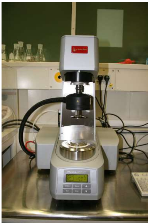
Abbildung 16: Ansicht des MCR 51-Rheometers der Firma Anton Paar. Beim Platte-Platte-Rotationsversuch befindet sich die Flüssigkeit zwischen zwei kreisförmigen Scheiben, deren eine sich über der anderen dreht. Angetrieben wird die obere Platte durch das Drehmoment M , welches die Rotationsgeschwindigkeit \omega erzeugt.
