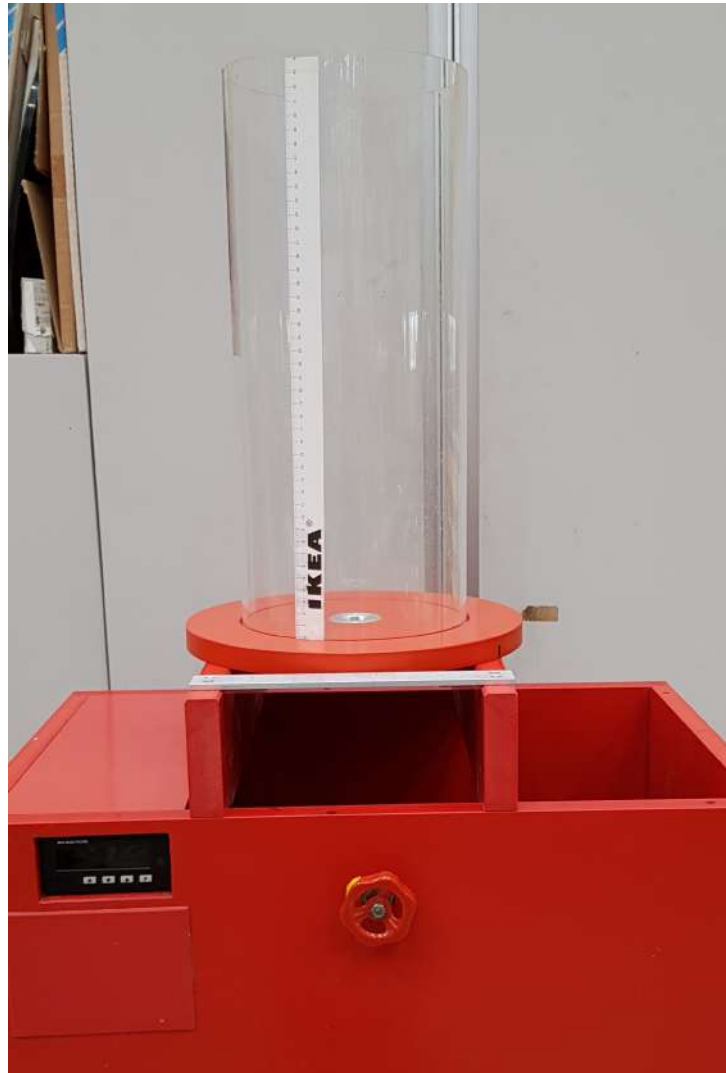
Abbildung 6: Versuchsstand zum Ausfluss aus einem Gefäß
