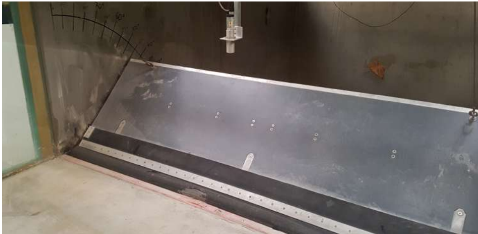
Abbildung 10: Modell eines neigungsvariablen Überfallwehres (Pivot-Wehr)
