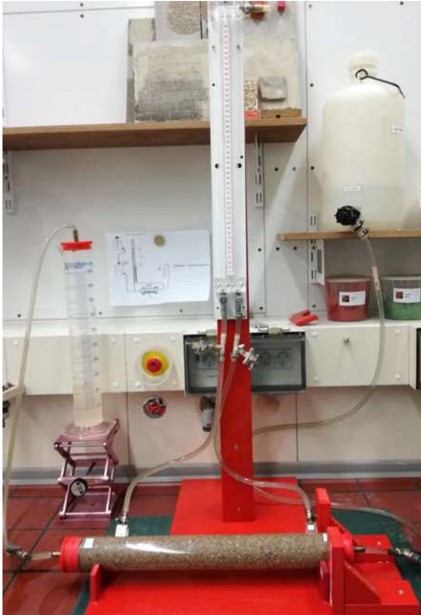
Abbildung 15: Versuchsstand zum Darcy-Gesetz im Sedimentlabor der UniBw
