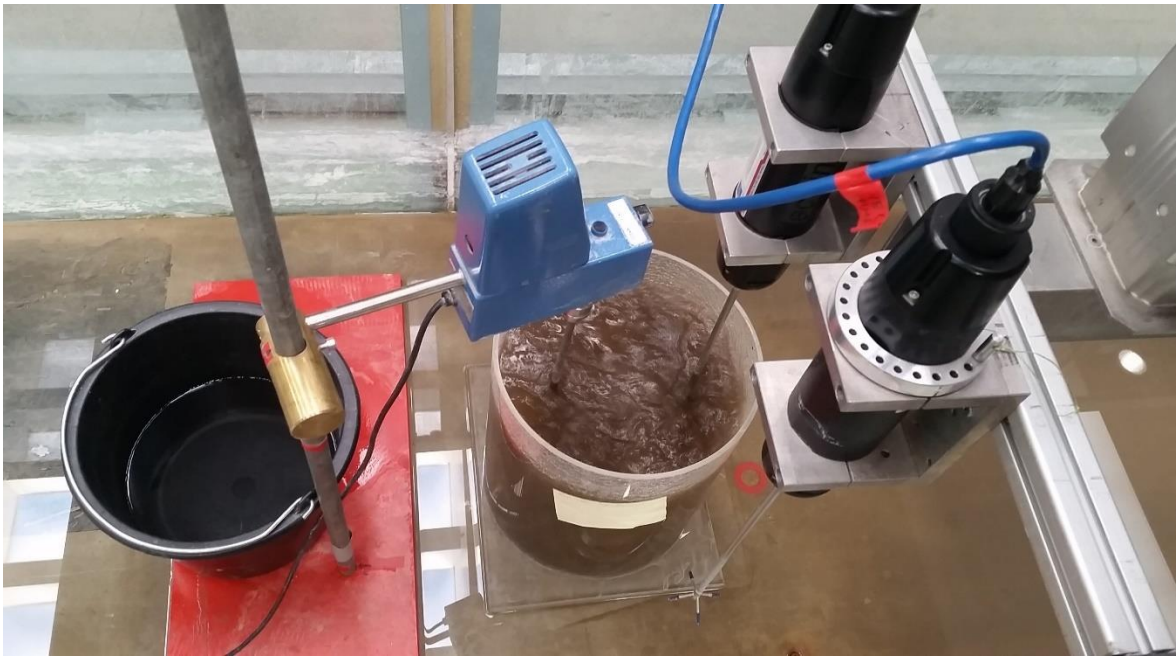
Abbildung 4: Versuchsaufbau mit Messzylinder, Rührer und ADV - Sonde, Quelle: Eigene Aufnahme
