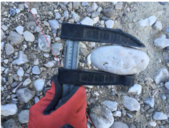
((a)) Grob gereinigter Stein beim Messen birgt weniger Potential für Messfehler
