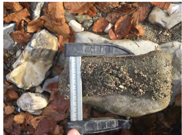
((b)) Verunreinigte Steine sorgen regelmäßig für Messungenauigkeiten, wenn diese nicht grob gereinigt werden
