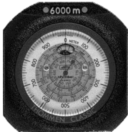
Abb. 2: Analoges Höhenmesser „Thommen Classic TX 22“ mit einem Meßbereich 0-6000 m in 10 m Intervallen
