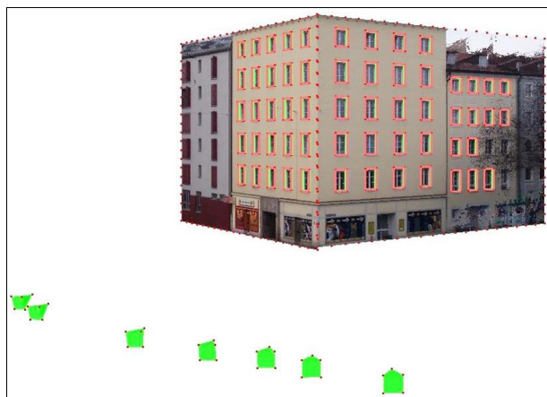
Abb. 5: Ergebnis der automatischen 3D Interpretation von drei Fassaden mit Kameras als grüne Pyramiden und Fenstern als rote Rechtecke.
