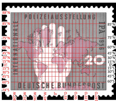
Abb. 11: Überlagerung einer Weltkarte in Mercator-Abbildung mit R = 3,95 \text{ mm} aus Formel [6].
