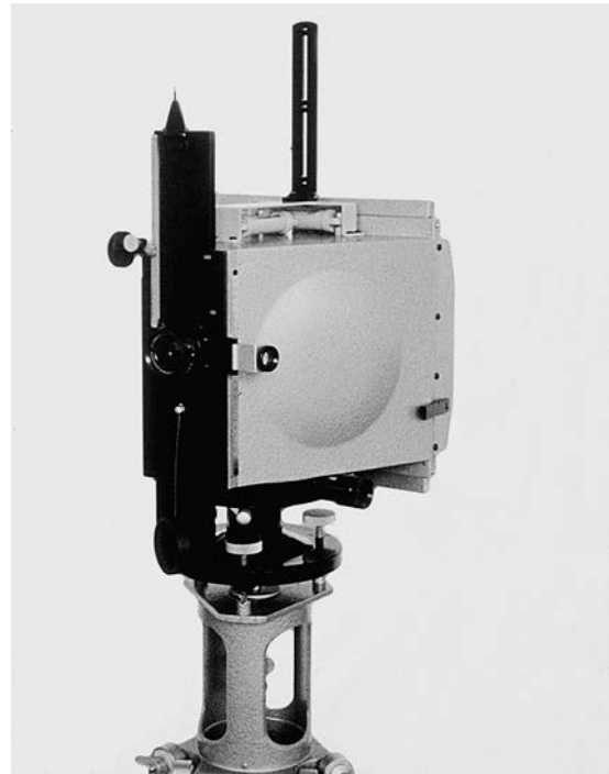
Abb. 1: Phototheodolit TAF (Terrestrische Ausrüstung Finsterwalder )
