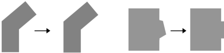
Abbildung 6.10: Große Winkelabweichungen müssen für große Strukturen beibehalten werden (links), für kleine Objektteile ist aber eine Orthogonalisierung sinnvoll (rechts).
