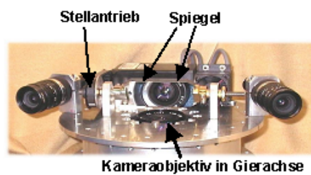
MarVEye6 (PKW): Gierplattform für alle Nickstabilisierung über Spiegel (nur Tele)
