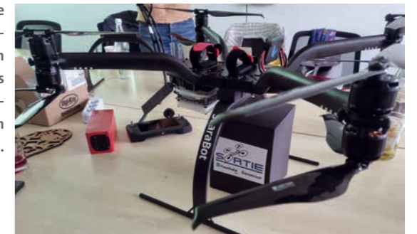
Diese Flugdrohne wird bei eingestürzten Gebäuden eingesetzt, um das Trümmerfeld mit verschiedenen Sensoren zu scannen.
