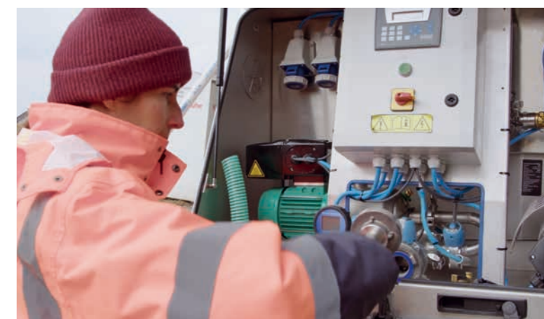
Das Projekt NOWATER hat eine Wasseraufbereitungsanlage als mobilen Einsatzwagen entwickelt.
