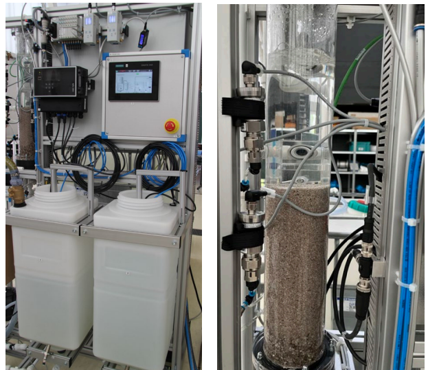
Abb. 2: Filtrationseinheit mit Sandfilter
