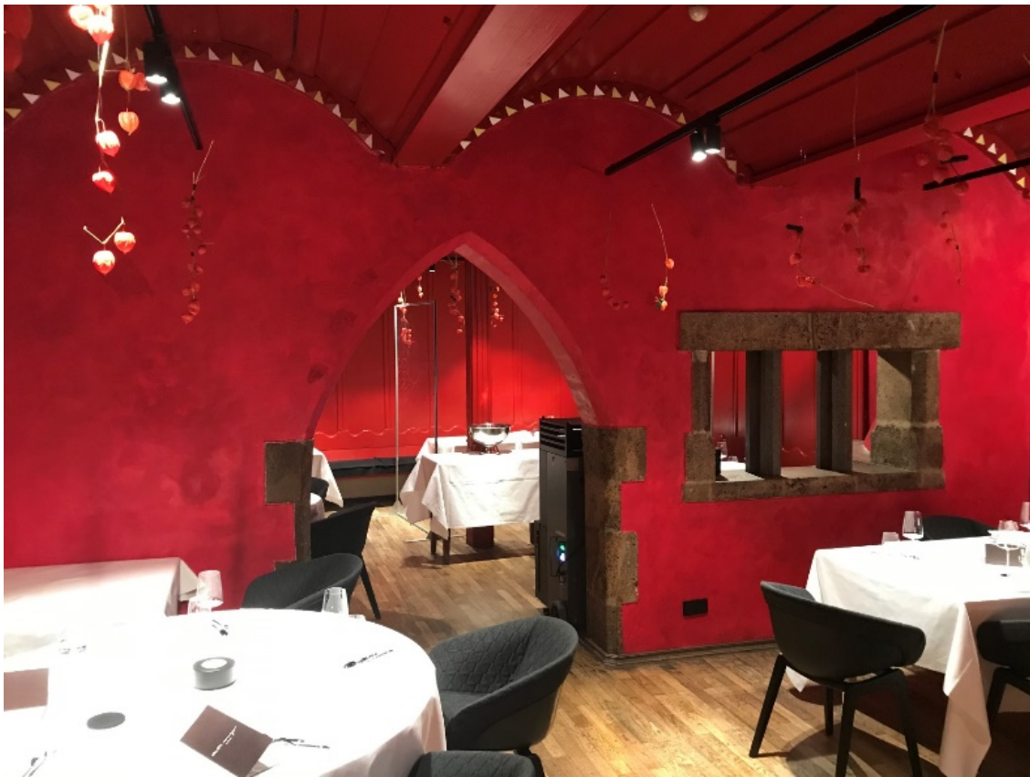
Abb. 1: Aufnahme zweier Gasträume, die durch einen Bogen und eine Öffnung in der Wand miteinander verbunden sind. Die Decke ist mehrfach gewölbt, was eine effiziente Luftreinigung erschwert.
