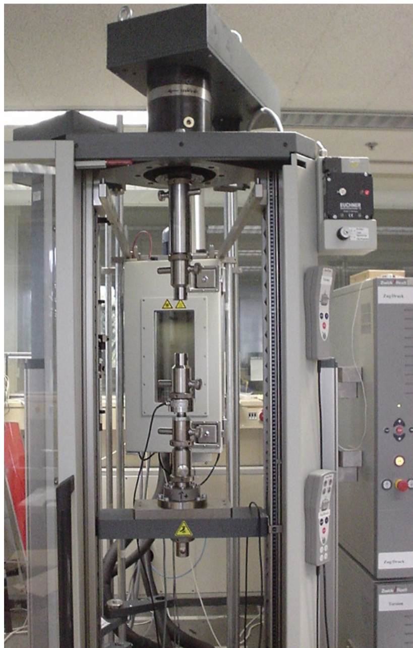
Abb. 4.1. Material-Prüfmaschine Zwick TC-Fr020TH.A50. Die Schutztür ist geöffnet. Im rechten Teil sieht man Steuereinrichtungen, deren obere (Zug/Druck) verwendet wurde. Im Hintergrund ist eine Temperierkammer zu erkennen, die nicht zum Einsatz kam.
