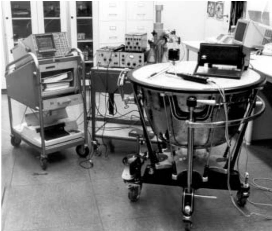
*Abb. 7. Versuchsaufbau zur Messung der akustischen Intensität an der großen Pauke mit Kessel C.*
