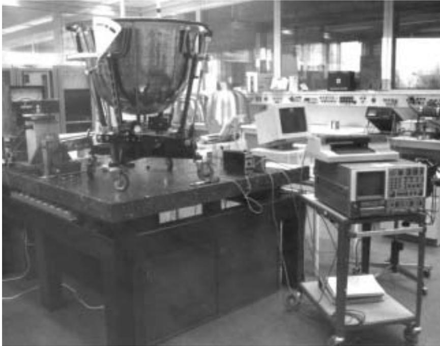
Abb. 14. Aufbau zur Schwingungsmessung am eingebauten Kessel.
