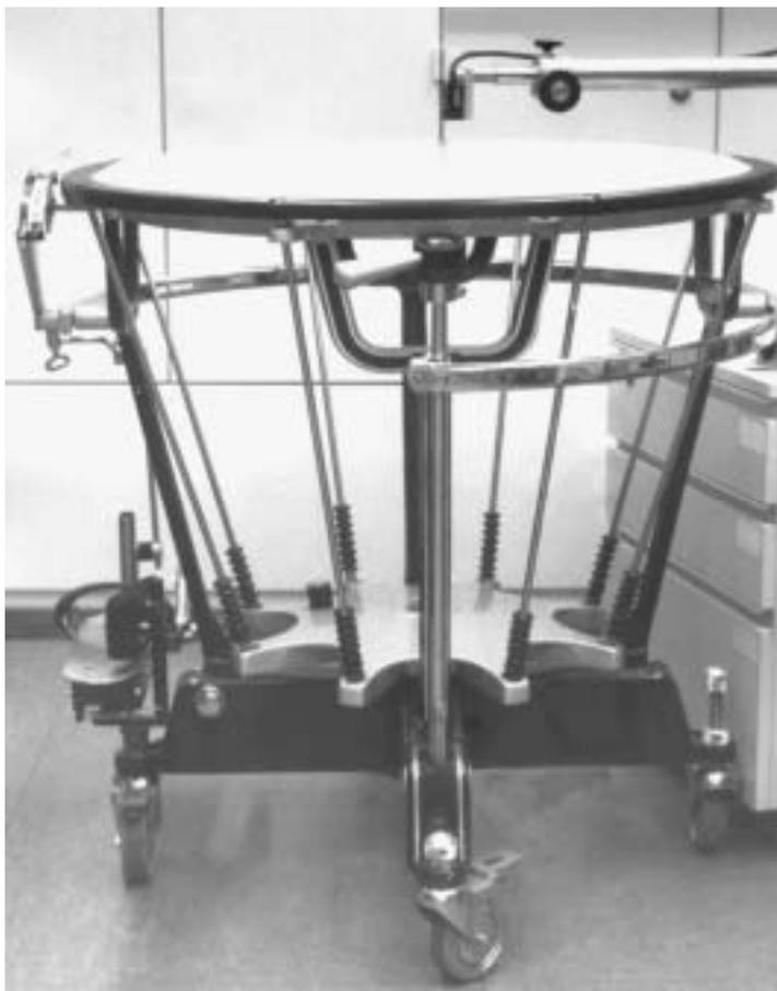
*Abb. 71. Große Kolberg-Pauke Nr. 2 ohne Kessel; über dem Fell ist der Laser-Abstandsmesser sichtbar.*
