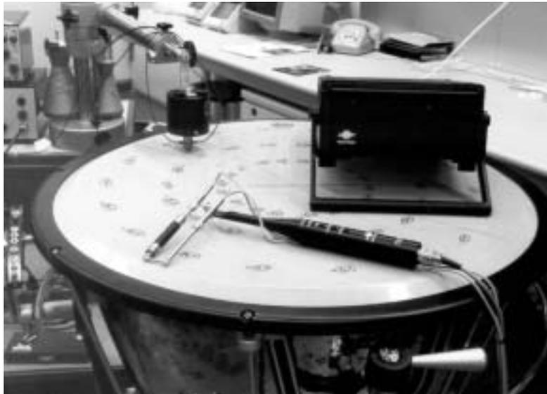
*Abb. 8. Messung der akustischen Intensität an der großen Pauke mit Kessel C: Schwingerreger (hinten), Schallintensitätsanalysator (Mitte) und Intensitätssonde (vorn).*
