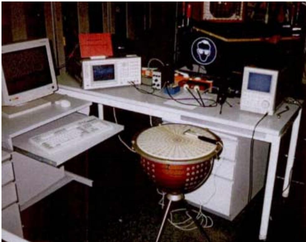
Abb. 29. Versuchsaufbau zur Messung an Kessel und Fell der kleinen Pauke.
