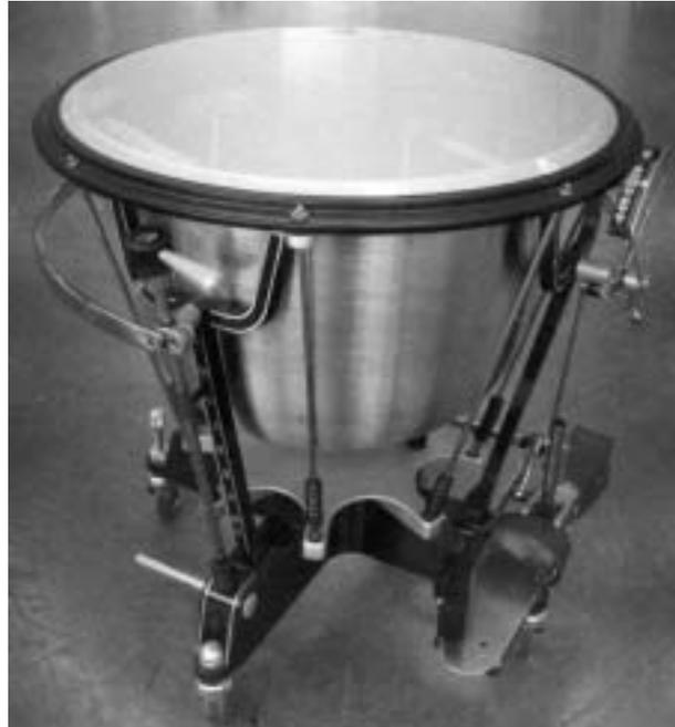
Daneben konnten für kürzere Zeit Messungen auch an einer Pauke Nr. 4 im Vierersatz durchgeführt werden. Diese „kleine Kolberg-Pauke“ ist in Abb. 5, bestückt mit einem Kunstfell und dem kupfernen Kessel, abgebildet. Auf die Instrumente der Abb. 3 bis 5 beziehen sich die folgenden Untersuchungen.
