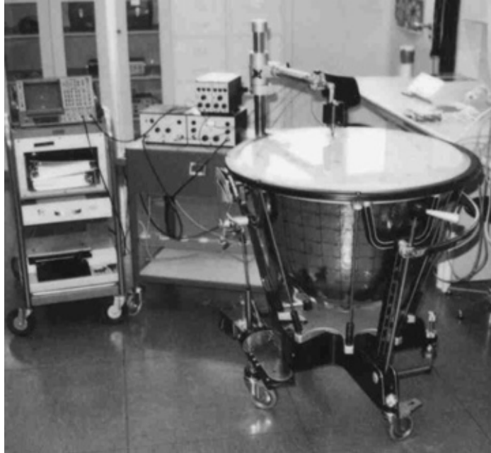
Abb. 23. Pauke mit Versuchsaufbau zur Messung der Impedanz/Admittanz.
