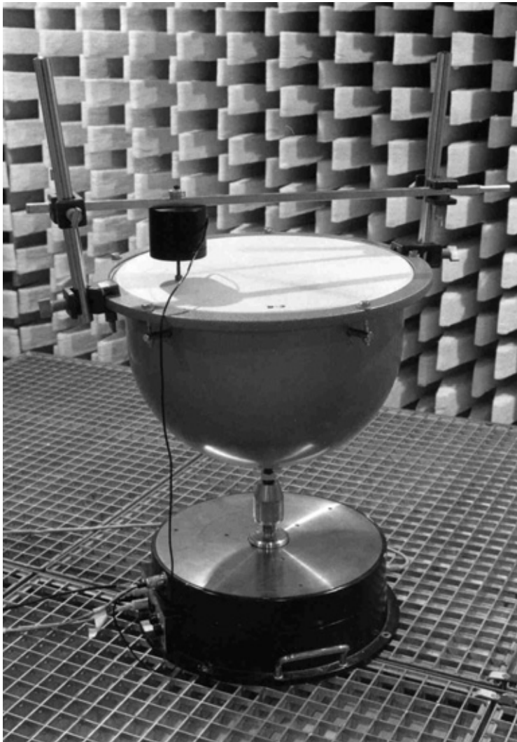
Abb. 13. Pauke III auf dem Drehtisch im reflexionsarmen Raum. Die Haltevorrichtung mit dem Schwingerreger, der das Fell zum Schwingen bringt, ist zu erkennen.
