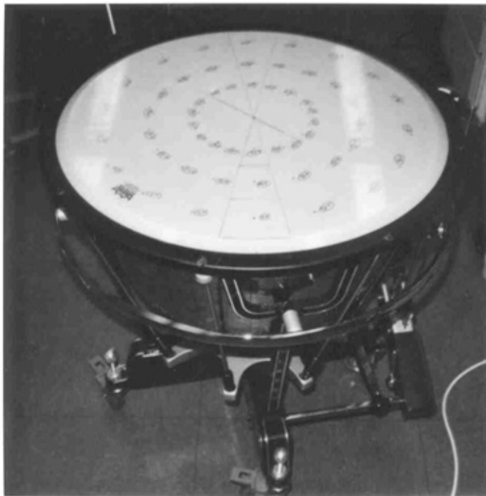
Abb. 24. Paukenfell mit aufgezeichnetem Raster für die Messung der Impedanz/Admittanz.
