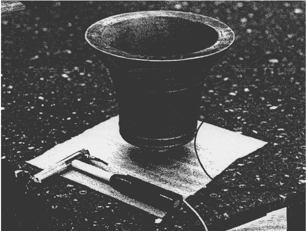
Fig. 17. Modalanalyse einer Glockenspielglocke; der Impulshammer sowie die Zuleitungskabel des Kraftaufnehmers und des Beschleunigungsaufnehmers sind zu erkennen.
