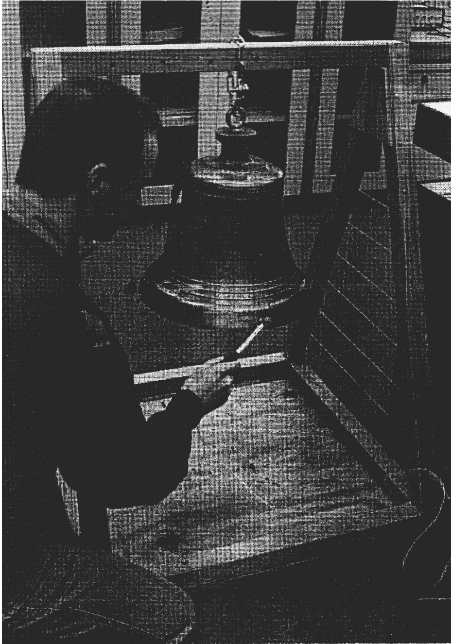
Fig. 13. Anregung der Perner-Glocke mit einem Impulshammer. Die auf diese Weise erzielten Ergebnisse der Modalanalyse finden sich in [48].
