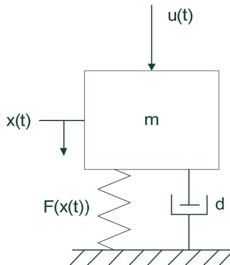
mit der Masse  $m$ , der Dämpferkonstante  $d$  und einer nichtlinearen Feder, deren Federkraft  $F(x(t))$  nichtlinear von der Position  $x(t)$  abhängig ist.
