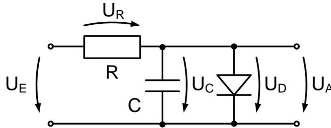
mit dem Widerstand  $R$ , dem Kondensator  $C$  und der Diode, welche durch die nichtlineare Strom-Spannungs-Beziehung  $i_D(U_D) = I_S \cdot (e^{k \cdot U_D} - 1)$  beschrieben wird.
