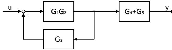
Abbildung 3: Zusammenfassung der Reihen- und Parallelschaltungen
