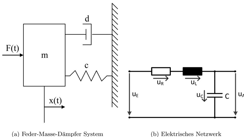
Das System in Abbildung a) wurde bereits in der ersten Übung behandelt und wird mit der Differentialgleichung
