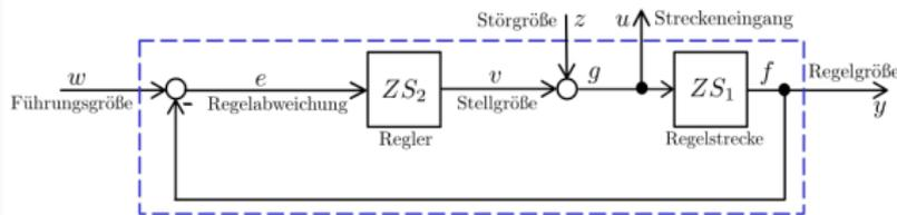
(i) Entwerfen Sie einen PID-Regler unter Verwendung der Methode des Stabilitätsrandes.
