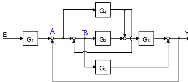
3.1 Bestimmen Sie die Übertragungsfunktion  $G_0$  des offenen Regelkreises,  $G_0(s) = Y(s)/E(s)$ , aus dem Blockschaltbild.
