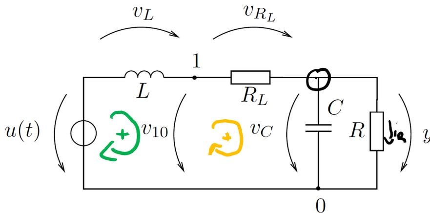
$$\text{I: } v_{10} = v_{R_L} + v_C = R_L \cdot i_L + v_C$$
