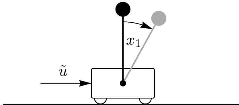
Die Beschleunigung  $\tilde{u}$  ist die Stellgröße des Systems,  $x_1$  der ange deutete Winkel und  $g$  stellt die Erdbeschleunigung dar. Masse des Stabes und Reibung des Wagens wird vernachlässigt. Die Dynamik ist durch folgendes Differentialgleichungssystem gegeben
