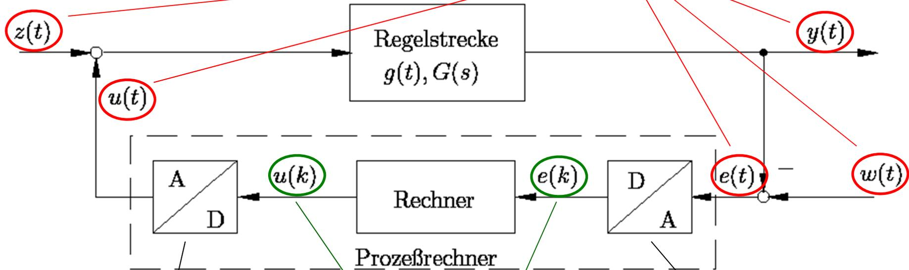
Bild 3.2: Regelkreis mit Prozeßrechnerregelung
