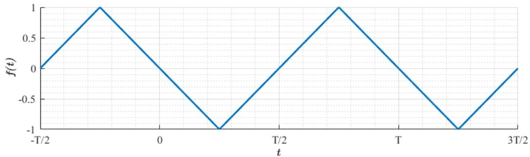
Abbildung 2: T-periodisches Dreiecksignal
