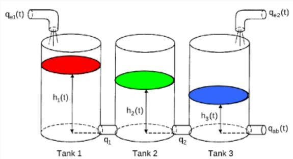
(i) Modellieren Sie die Strecke als Regelungssystem in Zustandsform mit den Zuständen  $h_1, h_2, h_3$  und den Eingängen  $q_{e1}, q_{e2}$ .
