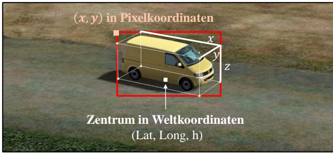
Abb. 38 Visualisierung des Prozesses zur automatisierten Bounding Box Generierung auf Basis der 3D Hülle um das zu detektierende Objekt und einer Transformation der Eckpunkte von Welt- in Kamerakoordinaten (vgl. [51]). Lat: Latitude; Long: Longitude; h: Höhe
