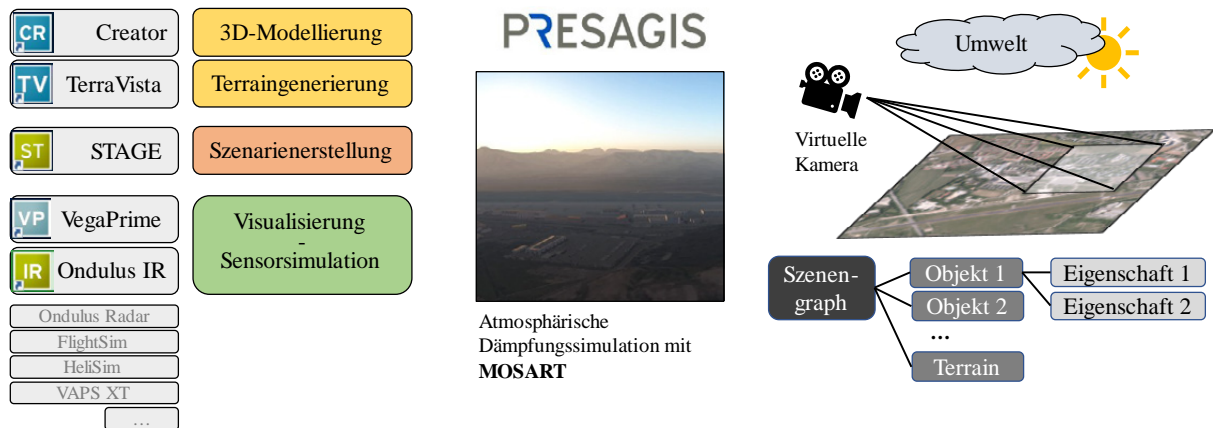
Abb. 7 Links: Modulbasierte Werkzeugkette der verwendeten Presagis Modellier- und Simulationsumgebung. Mitte: Beispielhafte Darstellung der atmosphärischen Dämpfungssimulation mit MOSART. Rechts: Schematische Darstellung der synthetischen Bildgenerierung und des zugrunde liegenden Szenengraphen. Quelle: vgl. [131]
