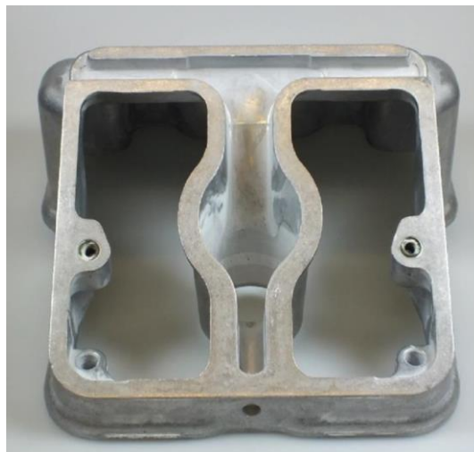
Abbildung 4: Originaler, abgenutzter Ventildeckel
