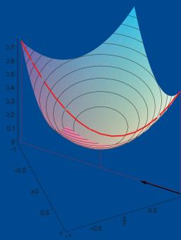
Bei **direkten Verfahren** werden **Zustand** und **Steuerung** durch Funktionen ersetzt, die sich durch endlich viele Parameter beschreiben lassen. Setzt man diese in die Nebenbedingungen und die Zielfunktion ein, so entsteht ein endlichdimensionales Optimierungsproblem. Zur numerischen Lösung werden häufig **Abstiegsverfahren** verwendet, die in einem Punkt  $z^k$  eine Abstiegsrichtung  $d^k$  bestimmen, dann eine Liniensuche
