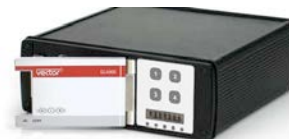
Realdatenmessung per CAN-Bus
