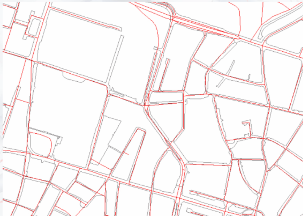
Vergleich der Strassengeometrie Hoch/Tiefbord Layer ALK mit Strassenmittellachsen von einem kommerziellen Anbieter
