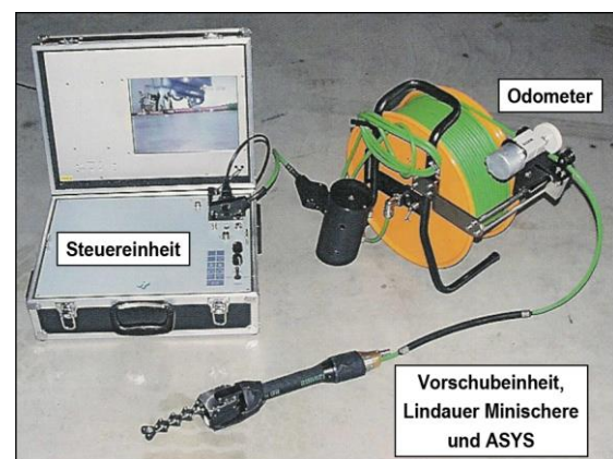
Abb. 4: Mobile Inspektionseinheit für den Schiebetrieb [HEISTER/REINHARDT, 2007].
