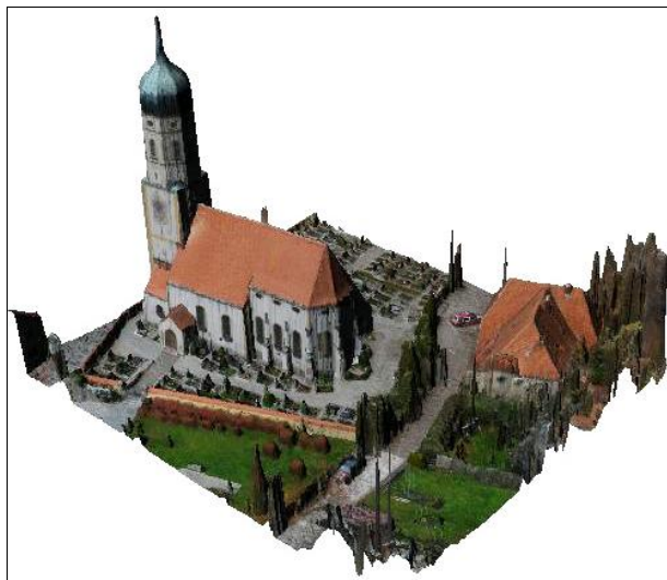
Abb. 4: Ergebnis für vollautomatische dichte Tiefenschätzung mittels Semi Global Matching (SGM) [Hirschmüller, 2008] auf Grundlage der hoch genauen Orientierungsbestimmung aus Bartelsen / Mayer [2010].
