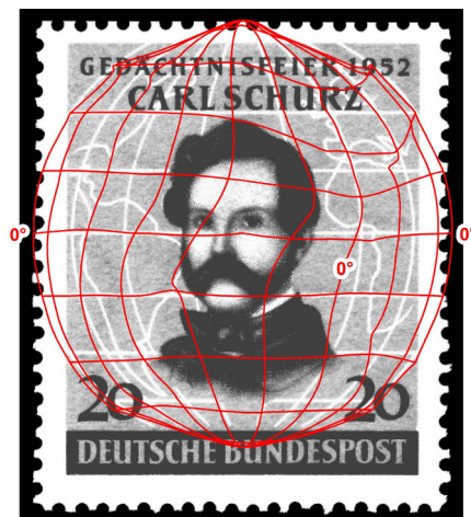
Abb. 5: Verzerrungsnetz mittels multiquadratischer Interpolation mit einer 20°-Gitternetzweite.
