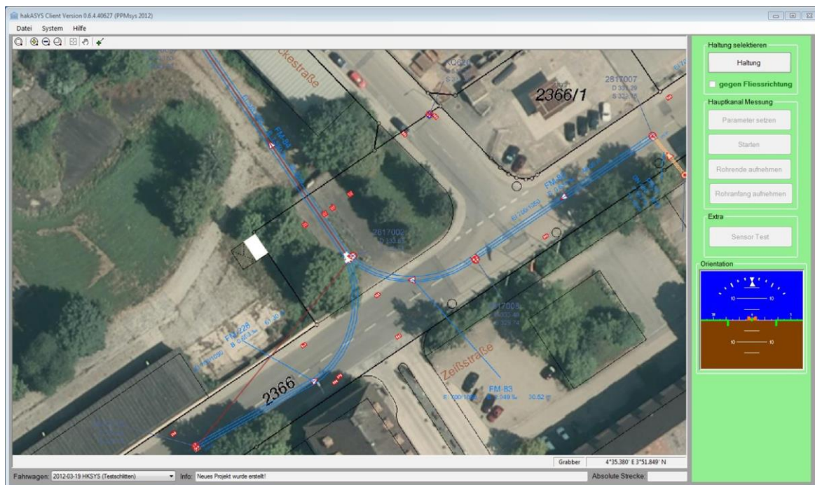
Abb. 13: Software zur Vermessung von Haltungen mit Hintergrundkarte des vorhandenen Bestandes [HÜMMER et al., 2013].
