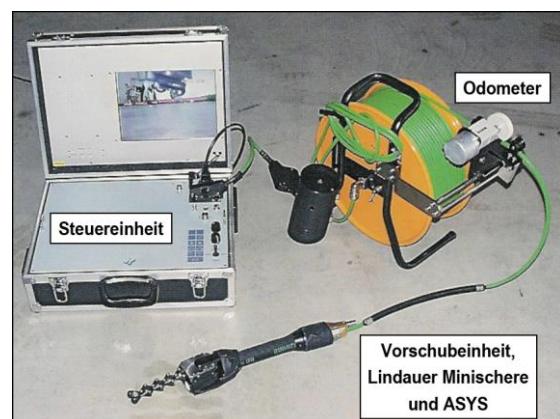
Abb. 4: Mobile Inspektionseinheit für den Schiebetrieb [HEISTER/REINHARDT, 2007].
