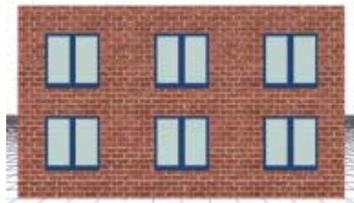
Abb. 76: Fassade mittels Teilflächentextur
