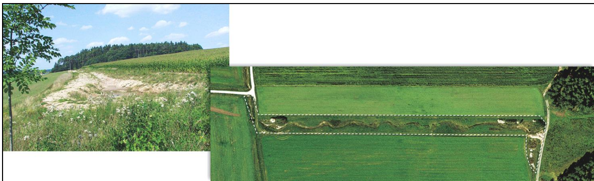
Abb. 4: Erosionsschutzstreifen zwischen hangparallel zugeteilten Grundstücken, der gleichzeitig auch zur Biotopvernetzung und Wasserrückhaltung in der Fläche beiträgt [aus KEMPE, 2011].
