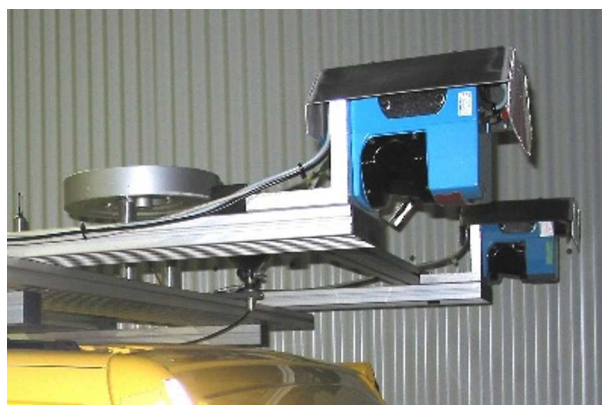
Abbildung 4.4.: Laserscanner-Messaufbau mit Ausrichtung beider Scanner nach unten.
