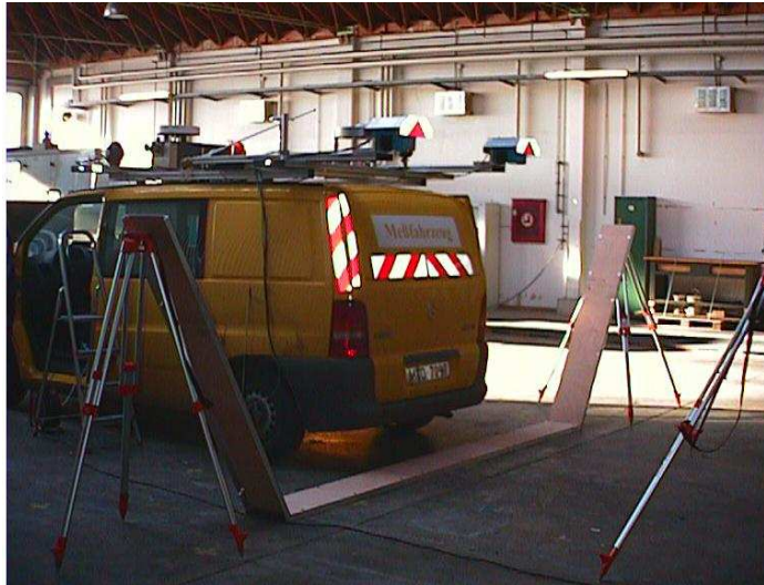
Abbildung 5.9.: Messaufbau zur geometrischen Kalibrierung der Laserscanner.
