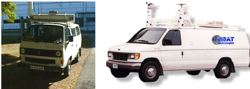
Abbildung 2.2.: Linkes Bild: Das kinematische Vermessungssystem (KiSS). Rechtes Bild: Das System VISAT der University of Calgary.
