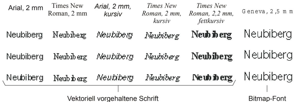
Abbildung 4.18: Bildstörung bei Schrift, Veränderung der Lage in der Bildpunktmatrix bei vektorieller Schrift und Konstanz der Lage in der Bildpunktmatrix bei Bitmap-Fonts
