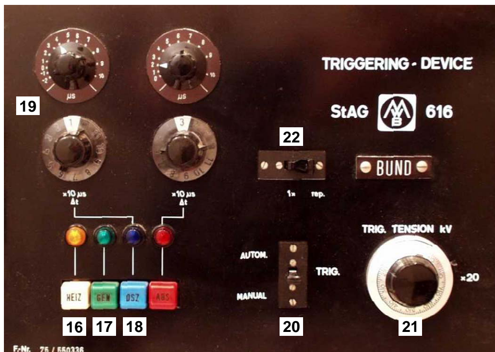
Bild 5: Stoßauslösegerät StAG 616 im Steuerpult
