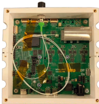
Kompakte Senderelektronik in einem 3D-gedruckten Gehäuse.
