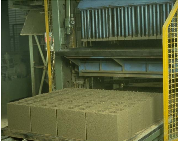
Bild 6: Hohlblocksteine auf dem Unterlagsbrett eines stationären Steinfertigers
